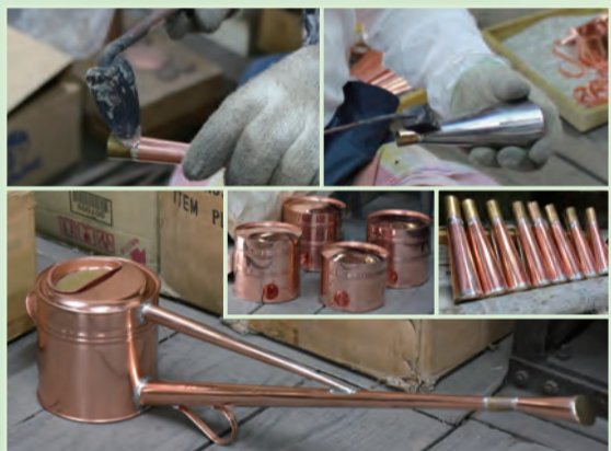
280度で溶かしたはんだで素早く部品をつなぎます。とても暑い中での作業です。
