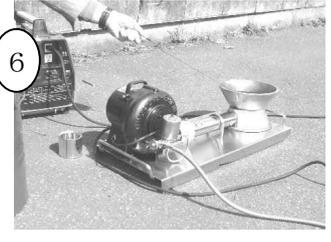
点火棒に③の灯油を浸して火をつけ、燃焼筒に入れる。
