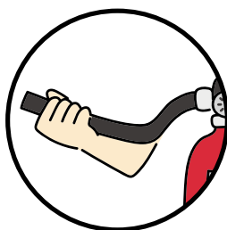
② 将软管对准起火点
