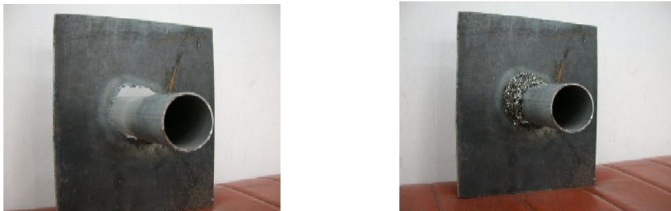
配管導入部などの隙間を金属タワシで塞いだ模型
