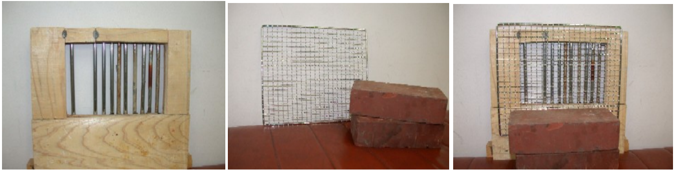
床下通風口を焼き網とレンガで塞いだ模型(焼き網を2枚重ねて8ミリ以下の目にするほうが良い。)
