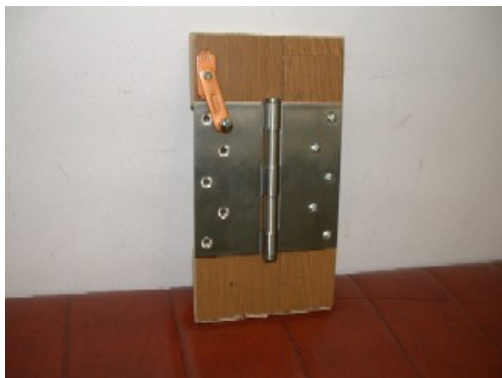
雨戸の戸袋の手掛けに蝶番と打ちかけを用いて蓋をした模型
