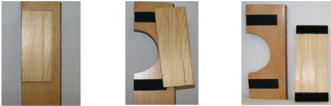
マジックテープを用いた手掛けの蓋(テープは万能接着剤で貼ってある)
