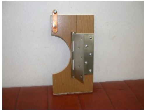
雨戸の戸袋の手掛けに蝶番と打ちかけを用いて蓋をした模型
