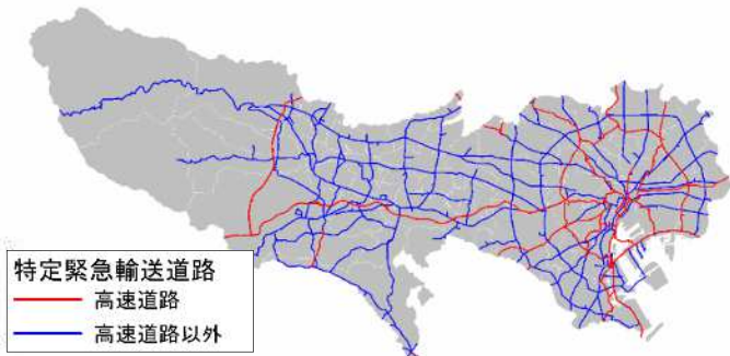
図3 使用する道路(特定緊急輸送道路)
