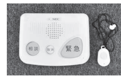
緊急通報システムの専用通報機(左)とペンダント型通報機(右)
