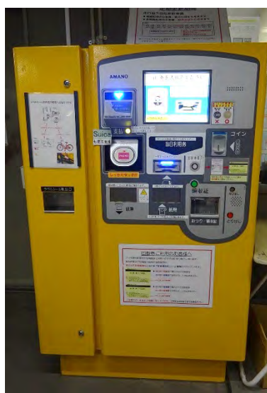
写真 交通系 IC カードでの電子決済に対応した料金精算機
