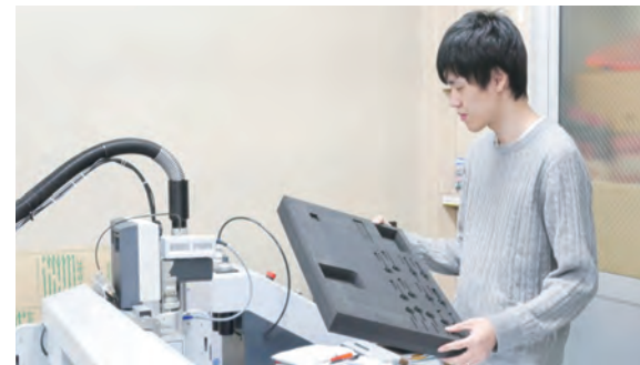
▲切り抜いたウレタンの確認作業。ちょうどよいサイズになるまで試行を繰り返します。
