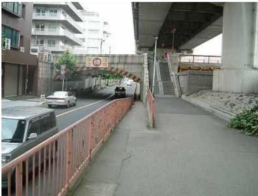
蔵前橋下の通路。極端に幅が狭くなっており、すれ違いが困難である。 蔵前橋に上がるのも階段しかない。この部分で車椅子や自転車が通行するのは難しい。
