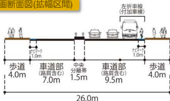
計画断面図(拡幅区間)
