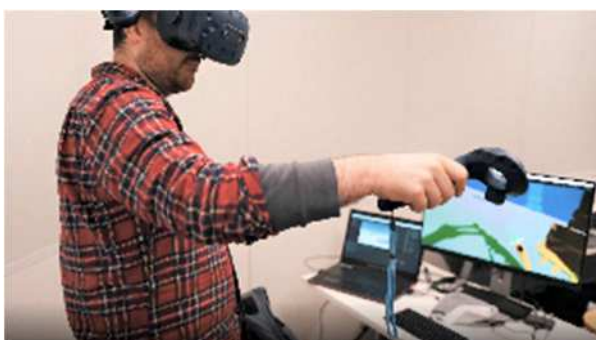
VR上に再現された現場を見て、コントローラーでロボットに指示をする様子
