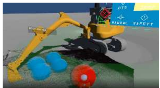
掘削したい場所は青で、すくいあげたものを置きたい場所は赤で表示されている
