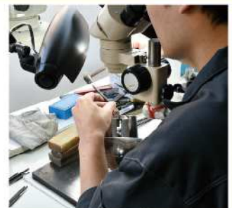
若手にも技術が継承 タガネを使用する精密刻印
